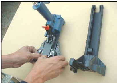
4. Resbale el mecanismo del acoplamiento y ajustador de altura de grapa (018) simultáneamente desde el collar (006).
