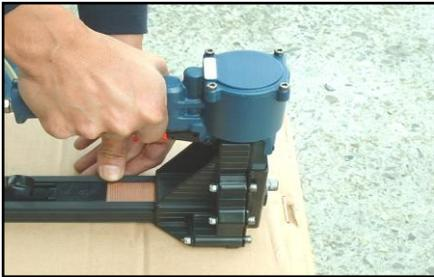
7. Para obtener un firme cerrado de la caja, es necesaria la aplicación de grapas de un extremo al otro, además de comprobar que el cerrado de la grapa tenga la profundidad y fuerza necesarias.
