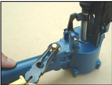
4. Quite la válvula (017) y el tubo (016) con las pinzas de nariz larga. Reemplace los o'rings que presentan desgaste o que hayan perdido su forma original. Vuelva a armar la herramienta en orden inverso.
