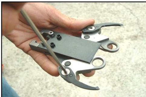
3. Afloje los tornillos (532) con la llave hexagonal de 3mm. CAMBIE LAS CUCHILLAS UNA POR UNA PARA NO CAUSAR CONFUSIÓN Y COLOCARLAS AL REVÉS.
