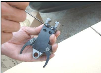
5. Afloje los tornillos (535) con la llave hexagonal de 3 mm. Saque los pernos (537) con el martillo y saca pernos de 6 mm.
