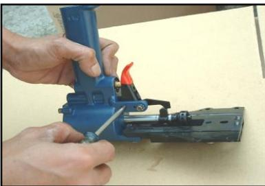
1. Afloje los tornillos (513) con un destornillador plano.
