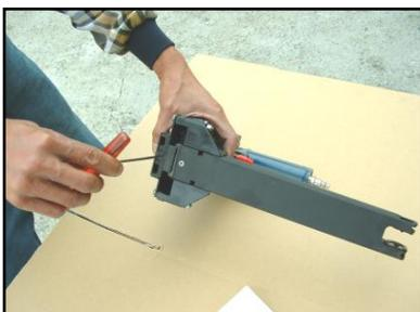
3. Afloje el tornillo de presión (526) con la llave hexagonal de 3 mm para abrir el ajuste de la barra (018).
