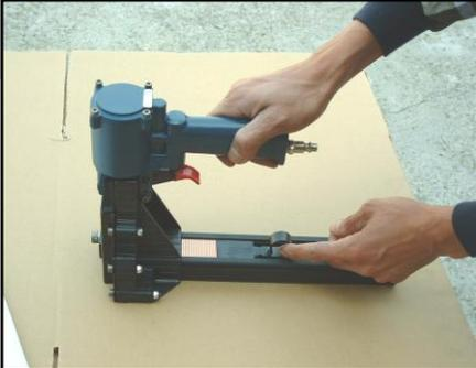
4. No permita que el empujador (036) se mueva hacia delante y golpee las grapas a su máxima velocidad, se podrían deformar las grapas o dañar la herramienta.
