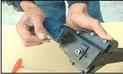
1. Use la llave hexagonal más pequeña, dé vuelta al volante o collar (006). Dé vuelta a la ventana en el sentido de las manecillas del reloj hasta que quede apretado el ajustador del cerrado de la grapa.
