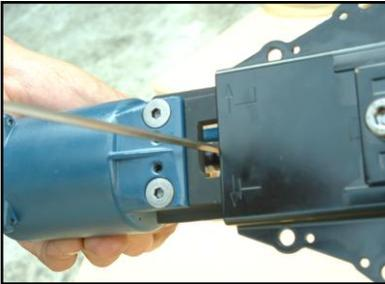
6. Afloje el tornillo (510) con la llave hexagonal de 3 mm quite el bloque a través de la ventana.
