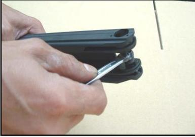
6. Ajuste la varilla (032) con 6 y retire el empujador
