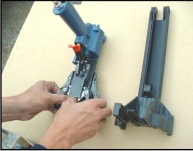
4. Resbale el mecanismo del acoplamiento, ajuste (018) la barra simultáneamente desde el collar (006).
