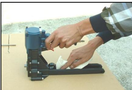
2. Para la limpieza se sugiere utilizar un desengrasante NO FLAMABLE. No permita que ningún solvente entre en el cilindro, se podría dañar. Seque completamente la herramienta antes de usarla.
