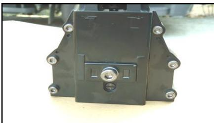
3. Cuando el borde superior de la placa (019) está en su ajuste más alto (No.4), las cuchillas (021,022) estarán en su penetración más baja. Si el sistema de ajuste está en su penetración más baja (No.1), las cuchillas (021,022) estarán en su penetración más profunda.
