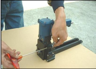
1. Afloje los tornillos (530,531) y la tuerca (542) con la llave de tuercas de 8 mm y la llave hexagonal de 4 mm.
