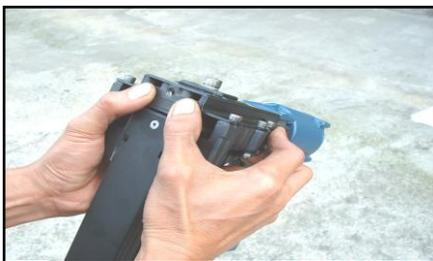
2. Presione el cuerpo (007) hacia arriba y ajuste la profundidad deseada.
