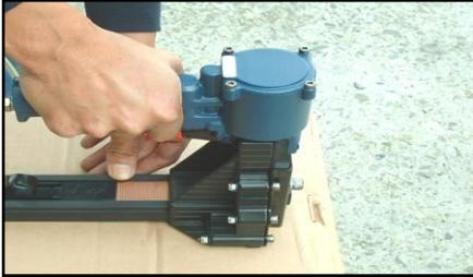
6. Coloque la herramienta sobre la caja con la grapa deseada. Hay una pequeña marca sobre cualquiera de los laterales del carro delantero (038) que sirven como auxiliar en la localización de la grapa (011)
