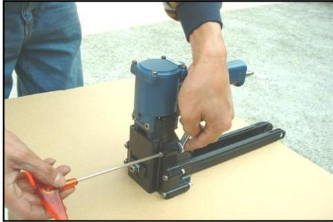
1. Afloje los tornillos (530,531) y la tuerca (542) con la llave de tuercas de 8 mm y de la llave hexagonal de 4 mm.
