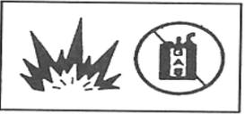
3. NUNCA USE GASOLINA U OTRO LÍQUIDO FLAMABLE PARA LIMPIAR LA HERRAMIENTA. EL VAPOR EN LA HERRAMIENTA PODRÍA PROVOCAR QUE SE INCENDIARA CON UNA CHISPA, PROVOCANDO QUE LA HERRAMIENTA EXPLOTE.
