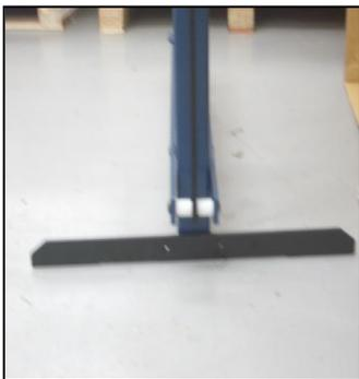
2. Use una llave hexagonal de 6 mm y una llave de tuercas de 13 mm para montar el balanceador (049).
