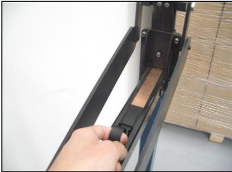
3. Tire el empujador (026) de nuevo a su posición y deje que apriete moderadamente las grapas. No suelte el empujador (026) rápidamente, ya que podría deformar las grapas o dañar la herramienta
