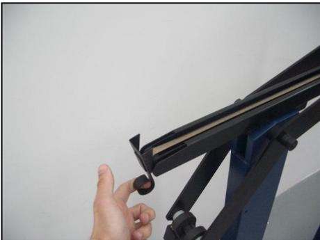
1. Tire el empujador (026) hacia atrás hasta que pare en el tope (024). Después dé la vuelta al empujador (026) hasta su posición.
