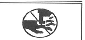
7. NUNCA COLOQUE SU CABEZA O CUALQUIER PARTE DE SU CUERPO EN LA CUCHILLA DE LA ENGRAPADORA ENTRE LA CUBIERTA B (016) Y EL MOLDE (016).
