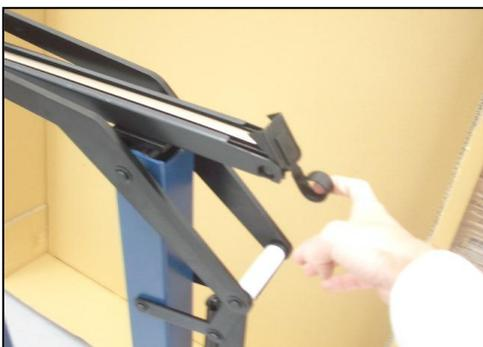
1. Tire el empujador (026) hacia atrás. Dé vuelta hasta su posición. Retire el resto de grapas.
