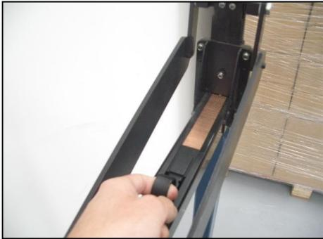
3. Tire el empujador (027) de nuevo a su posición y deje que apriete moderadamente las grapas. No suelte el empujador (027) rápidamente, ya que podría deformar las grapas o dañar la herramienta.
