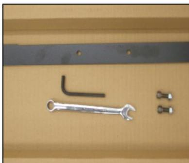
2. Use la llave hexagonal de 6mm y una llave inglesa de 13mm para montar el balanceador (031).
