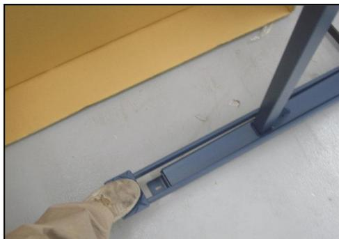
5. Presione el pedal (044) hacia abajo con el pié hasta que pare. Después vuelva a oprimir el pedal (044).
