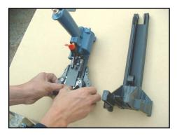
4. Quite el mecanismo del acoplamiento y de la barra de ajuste (012) simultáneamente del cuerpo (001).
