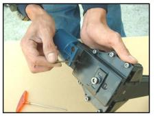
Afloje la tuerca del ajuste (011). Dé vuelta al tornillo de ajuste (010) a la derecha (hacia adentro) para aflojar el ajustador del cerrado de grapa. Dé vuelta al tornillo de ajuste (010) a la izquierda (hacia fuera) para apretar el ajustador del cerrado de la grapa, después de ajustar, apriete la tuerca (011).
