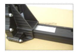
3. Para un cerrado fuerte es necesario que las grapas queden bien cerradas hasta el final de la caja. Revise los requerimientos del empaque. Realice pruebas en caja de muestra.
