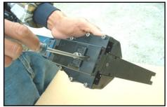
2. Dé vuelta a la barra ajustadora (012) 180° con un desatornillador al ajuste deseado.
