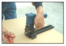
1. Afloje los tornillos (508,509) y la tuerca (520) con la llave de tuercas de 8 mm y de la llave hexagonal de 4 mm.
