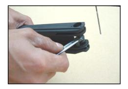
6. Afloje la barra (026), con una llave compensada de 6 mm quite las guías del empujador (033). Quite el empujador (030).
