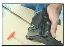
1. Afloje el tornillo delantero (505) con la llave hexagonal de 4 mm.
