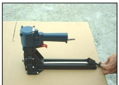
3. Jale el empujador (030) hacia atrás hasta que pare en la barra (026), después dé vuelta al empujador (030) hasta su posición.
