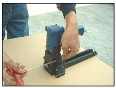
1. Afloje los tornillos (508,509) y la tuerca (520) con la llave de tuercas de 8 mm y con la llave hexagonal de 4 mm.
