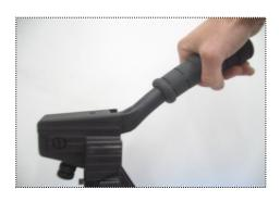
2. Coloque la caja en la posición deseada para la colocación de la grapa. Hay una pequeña protección en cada una de las partes del asiento del compartimiento (032) como ayuda para localizar la posición de la grapa. Mantenga el extremo delantero de la herramienta presionado en la tapa del cuerpo (001). Presione hacia abajo la manija (002) todo el camino hasta que pare. Suelte la manija (002) y coloque la herramienta en su siguiente posición.
