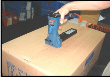
5. Tome la herramienta con una mano. Coloque la herramienta sobre la caja con la grapa deseada. Presione el gatillo (011) y libérela después del disparo. Mueva la herramienta a la siguiente locación deseada.
