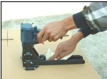
3. Para la limpieza se sugiere utilizar un desengrasante NO FLAMABLE. No permita que ningún solvente entre en el cilindro, se podría dañar. Seque completamente la herramienta antes de usarla.
