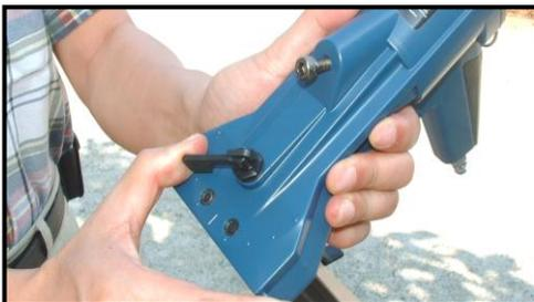
1. Presione hacia abajo el rodillo de ajuste (017) en contra del sentido de las manecillas del reloj. Usted debe encontrar el cuerpo (15) hacia arriba. Deje el rodillo de ajuste (017) en la posición deseada.
