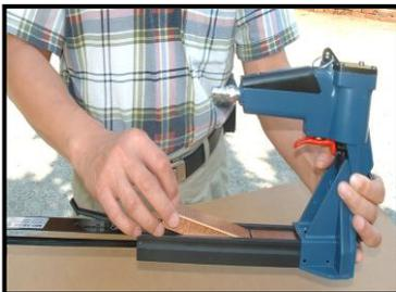
3. Inserte la tira de grapas dentro de la herramienta siguiendo las instrucciones de cargando la herramienta.
