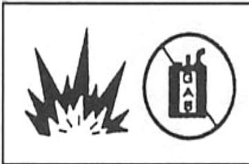
1. Nunca use gasolina u otro líquido inflamable para limpiar la herramienta, los vapores de estos líquidos en la herramienta pueden provocar que se quemé con una chispa y esto provocaría que la herramienta explote, por lo que los operarios podrían morir o quedar gravemente heridos.
